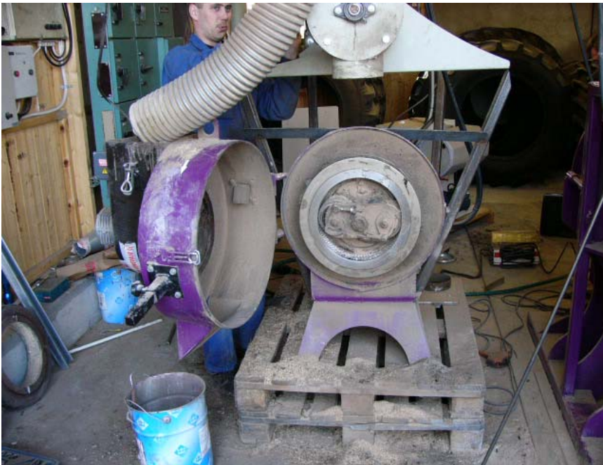
Kuva 2. Tilannekuva pelletöintikokeesta. Kuvassa rumpumatriisin suojakotelo avattuna (kuva Kimmo Ahola).
