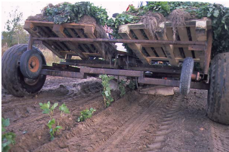
Kuva 4 Hankkeen aikana kolme viljelijää rakensi pensaiden istutuskoneen, jota he vuokrasiivat muille viljelijöillekin. Kone helpottaa istutustyötä huomattavasti.
