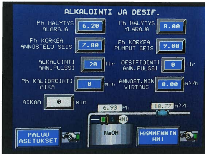
Kuva: Vartin vedenottamo ohjauslogiikka, alkalointi ja desifiointiasetukset
