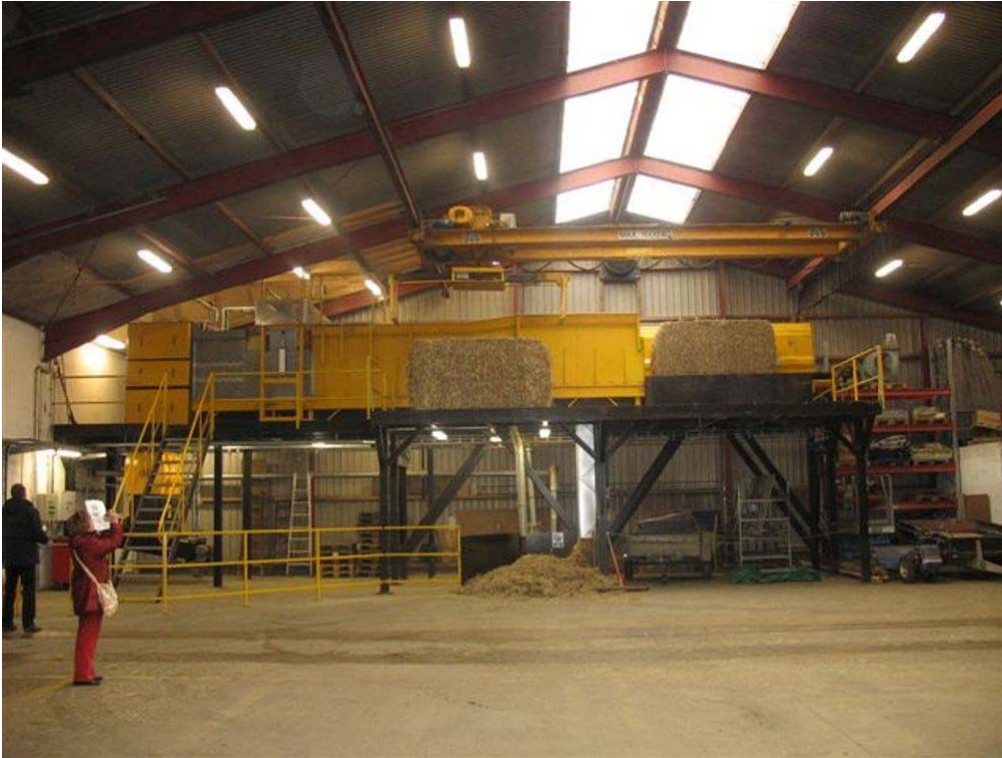
Kuva 16. Matkalla käytiin tutustumassa Harlev Varmeværkin olkea polttoaineena käyttävään 5,7 MW:n polttolaitokseen.
