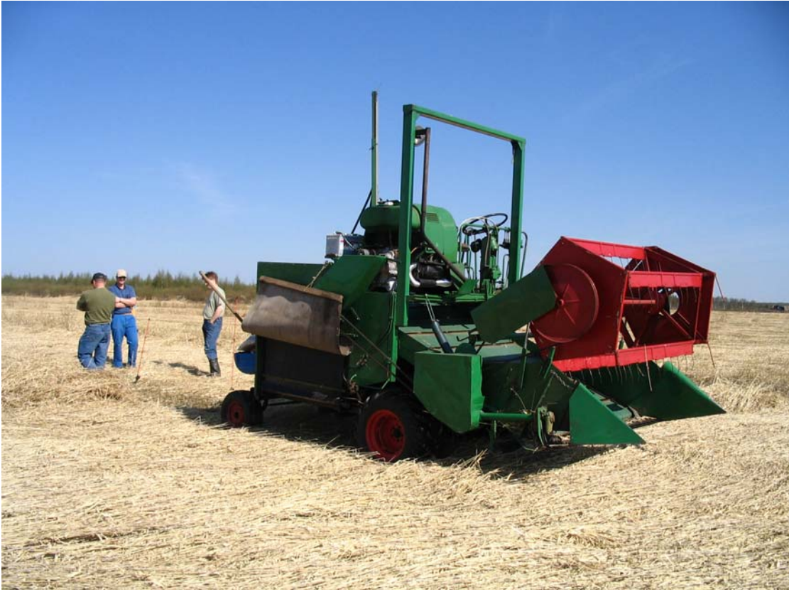
Kuva 10. Ruokohelpikasvustojen biologinen sato määritettiin MTT:n koeruu- tupuimurilla 8.5.2006.
