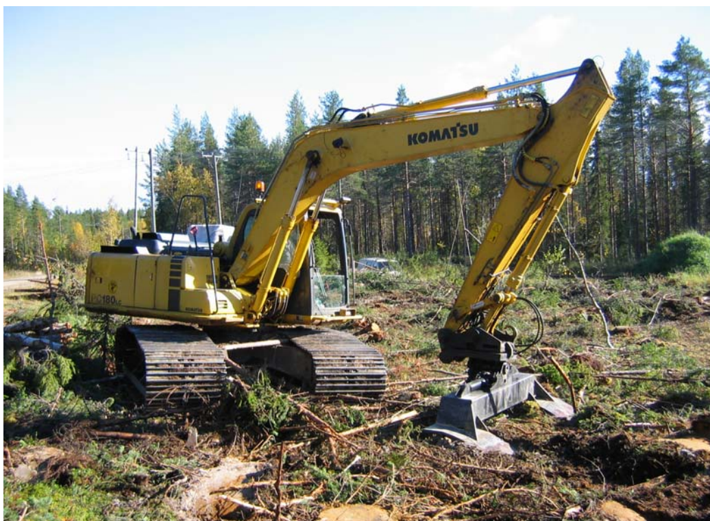
Kuva 18. Hankkeessa kehitetty laikkumätätystyslaite. Kuva: Samuli Kempainen.
