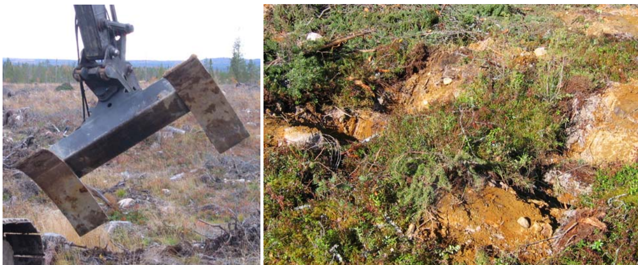
Kuva 19. Laikkumätätyslaite ja sen avulla tehdyt mätätät. Kuvat: Eeva Pudas ja Samuli Kempainen.
