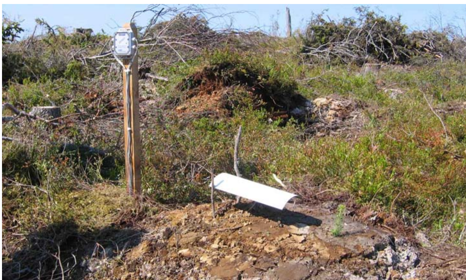
Kuva 13. Lämpötilamittauksissa käytetty säteilysuoja. Kuva: Samuli Kempainen.
